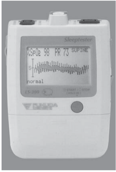
体にセンサーをつないで心電図や脈拍、呼吸、酸素濃度などの情報を集める機械。縦10センチ、横7センチで140グラム。装着しても睡眠を極力妨げません。
